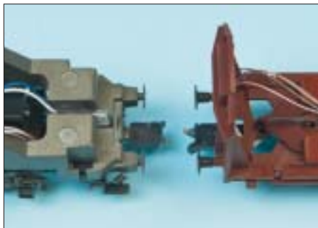
Links und rechts: Lok und Wagen, fertig zugerüstet mit den TC-H0-Kupplungen und den T4T-Decodern – zur besseren Erkennbarkeit wurden sie hier ohne Gleis fotografiert. Die Kupplungen rasten leichtgängig ein, sogar auf Radien. Aufnahmen: FZ (2), RZ (2)
