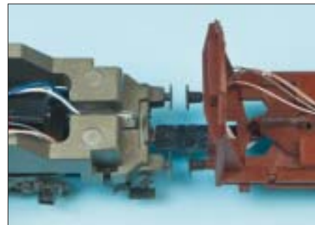
Links und rechts: Lok und Wagen, fertig zugerüstet mit den TC-H0-Kupplungen und den T4T-Decodern – zur besseren Erkennbarkeit wurden sie hier ohne Gleis fotografiert. Die Kupplungen rasten leichtgängig ein, sogar auf Radien. Aufnahmen: FZ (2), RZ (2)
